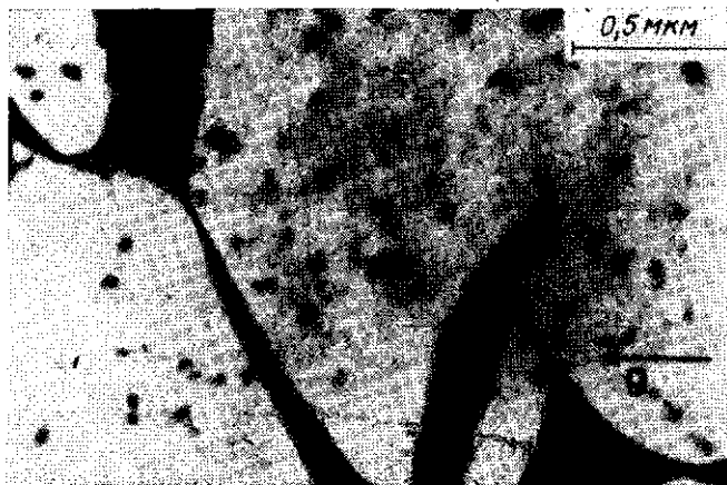
Рис. 19. Темнопольное изображение в сверхструктурном рефлексе \vec{g} = (110) в полностью упорядоченном образце \text{Cu}_3\text{Al} , облученном ионами меди энергий 30 кэВ. Темные точки представляют собой зоны нарушения дальнего порядка, вызванные смещениями атомов при облучении ионами. Темные полосы обусловлены антифазными границами
